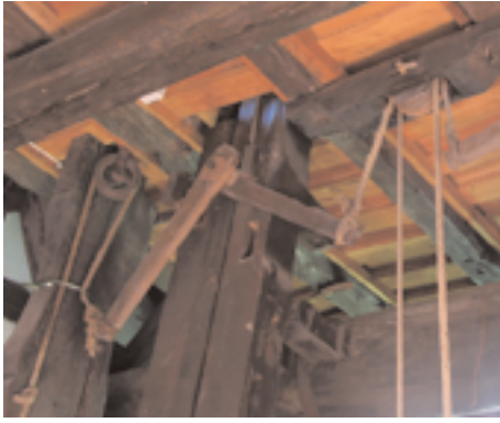
Die Halter der Stößel, diese greifen in die Rückseite der Nocken ein, und verhindern so ein Eingreifen der Hubnocken
