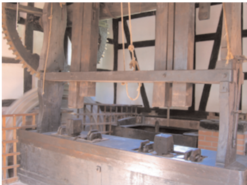
Die Keilpresse der Ölmühle Mömbris. Oben die Stößel, unten der Presstisch mit den bestückten Pressgruben. An der Wand links sieht man Kammrad und Pertnerrad
