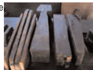
Bestückung der Presse v.l.n.r. eiserne Pressplatte Presstasche eiserne Pressplatte Lösekeil Holzbeilage Presskeil
